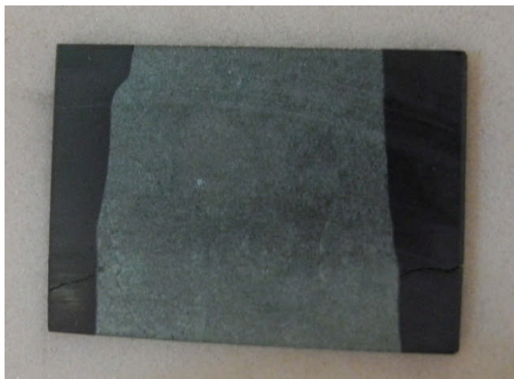
Рисунок 11 – Пластина толщиной 0,74 мм из \text{MoC}_{0,82} вырезанная непосредственно из контейнера, в котором плавился \text{MoC}_{0,82}
