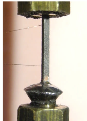
Рисунок 12 – Фотография образца из \text{MoC}_{0,82} сечением 0,74 x 0,9 и длиной 8.5 мм, закрепленного в рабочей ячейке КВД с подвижной цангой
