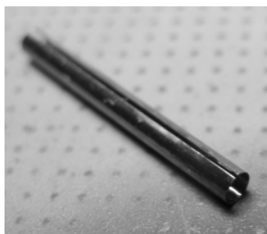
Рисунок 14 – Фотография трубчатого металлического образца толщиной 0,05 мм (диаметром 2 мм, длиной 15 мм)
